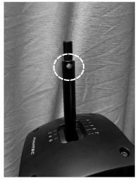
1. シフトノブを外す 反時計回りにノブを回すと外せます。 シフトノブを外すとシャフトに 貫通穴が見えてきます。
