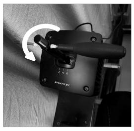
**2. 金属棒を使って、シャフトを外す** シャフトはしっかり固定されていますが、 反時計回りに力をかければ外せます
